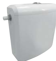
T1801-S Splachovacia nízko položená nádržka vrátane splachovacieho a bočného napúšťacieho mechanizmu, pripojovacia rúrka materiál ABS, 350x360x125 mm
