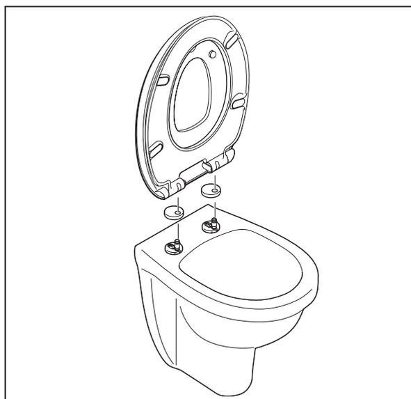
Držte sedátko ve vertikální poloze, vložte závěsné panty do pantů na WC míse.
