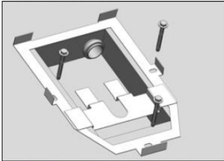
04 Upevněte rám pomocí tří šroubů, které jsou součástí balení.
