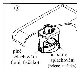
Zakryjte nádrž a ujistěte se, že konce silné a slabé tyčinky jsou správně umístěny na tlačítka ventilu.
