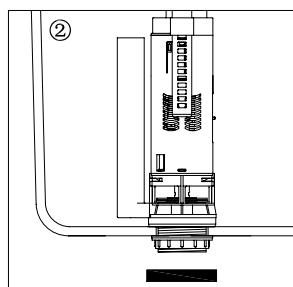
Umístěte gumové těsnění do upevňovací matice.
