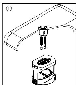
Vložte tělo tlačítka do otvoru ve víku nádrže a nasadte držák tlačítka na tělo tlačítka. Otáčením nastavte držák tlačítka do správné výšky
