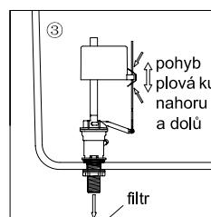
Stiskem úchytky a pohybem plováku podél táhla nastavte požadovanou úroveň vody. Vždy vyčistěte filtr.
