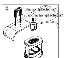
Upevněte tělo tlačítka a instalujte regulátory splachování
