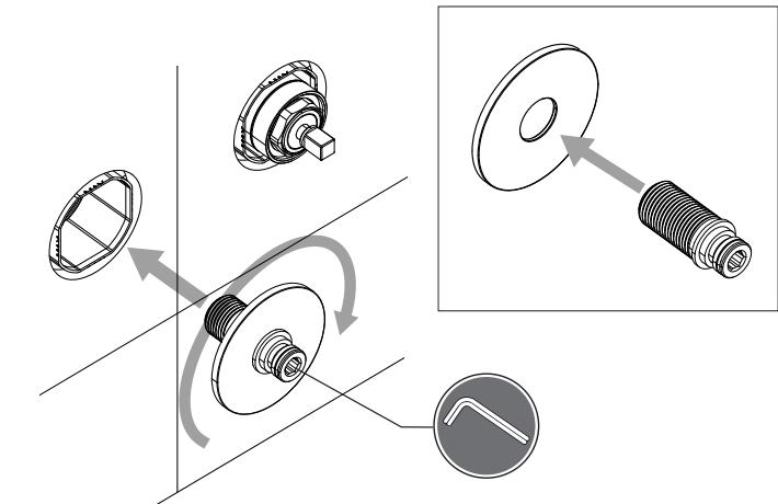
**5) Namontujte držák sprchy tak, že jej nasunete na armaturu a vráťte na miesto dôvode odstranený upevňovací šroub. Ten poté utiahnite pomocou imbusového klíča.**
