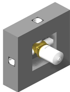
**1) Napojte prívodné trubky vody podle výše uvedeného schématu na podomietkové telo baterie a baterii zazdľete s ohľadom na tloušťku následne povrchové úpravy stien (obklady, stierka atď.)**
