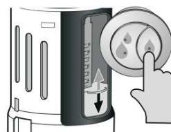
7. Stiskněte tlačítka polovičního splachnutí. Ujistěte se, že se nádoba dostatečně vyprázdní a že je aktivována funkce sifonu. Pokud není aktivován sifon, upravte nastavení 1/2 splachování (modré) o jeden stupeň dolů na 8.5. Znovu stiskněte tlačítka polovičního splachnutí. Tento postup opakujte, dokud nebude aktivována funkce sifonu.
